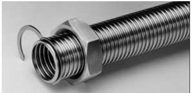
6. Klemmring in das erste Wellental einlegen und zu einem geschlossenen Ring zusammendrücken. Dichtung einlegen, Einschraubteil aufsetzen und mit zwei Sechskantschlüsseln anziehen.
