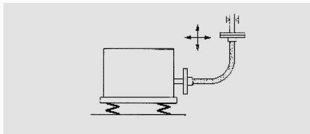
Bei Anschluss an schwingende Aggregate Rohrleitung direkt nach der Schlauchleitung fixieren.
