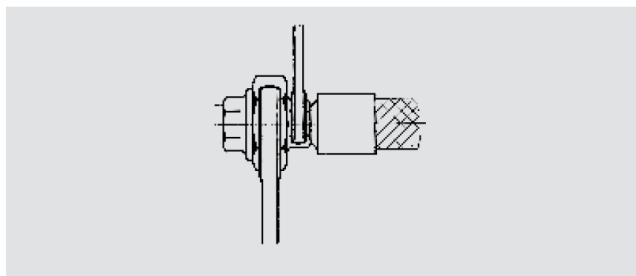
**Auf verdrehungsfreien Einbau achten;** bei Schraubverbindungen unbedingt mit Zweischlüssel oder Rohrzange gegen halten.
