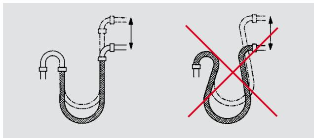
**Eviter les courbures trop importantes au niveau des pièces de raccordement en utilisant par exemple des coudes rigides; ceci vaut également dans le cadre des manipulations.**
