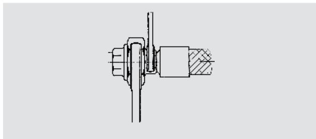
**Raccorder le flexible de manière à ce qu'il ne subisse aucune torsion.** Pour les raccords vissés utiliser une deuxième clé pour maintenir le tuyau lors du serrage.
