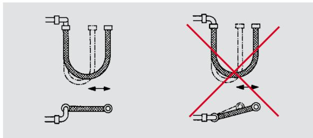
**Effectuer le montage de manière à ce que le mouvement et l'axe du tuyau soient dans le même plan.** Ceci évite les torsions préjudiciables.
