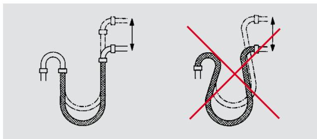
Gegenarmaturen so wählen, dass an den Anschlüssen ein **Abknicken** der Schlauchleitung **verhindert** wird (Winkel, Bögen usw. einsetzen); gilt auch für manuellen Gebrauch.
