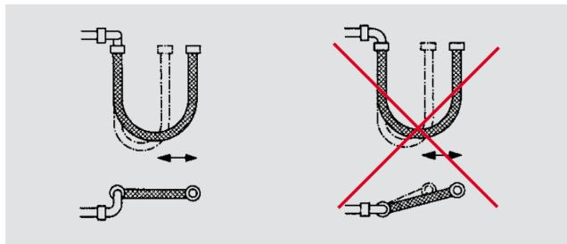
Schlauchleitung möglichst **in einer Ebene montieren**, verhindert Torsionsbeanspruchung bei Bewegung.
