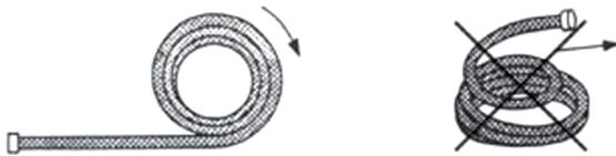
Die Schlauchleitung durch Abrollen des Schlauchbundes gerade legen. Nicht einfach am Schlauchende eines Bundes anziehen, da hierdurch der Schlauch zu stark gebogen oder geknickt werden kann. Flachschräume sind stets in ihrer vollen Länge zu verlegen.
