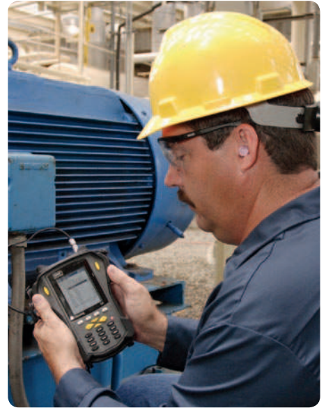
Schwingungsmessung mit Hilfe des SKF Microlog Datensammlers/-analysators
